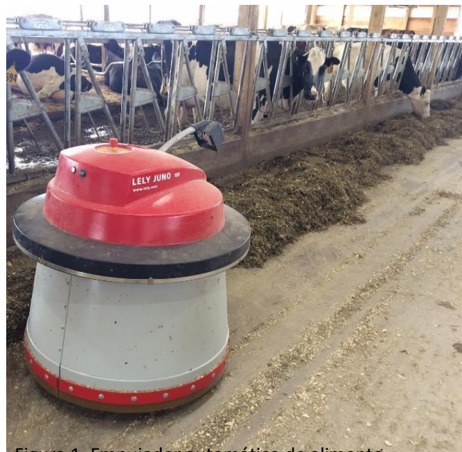
Figura 1. Empujador automático de alimento que empuja alimento por hora durante 22 horas al día.
